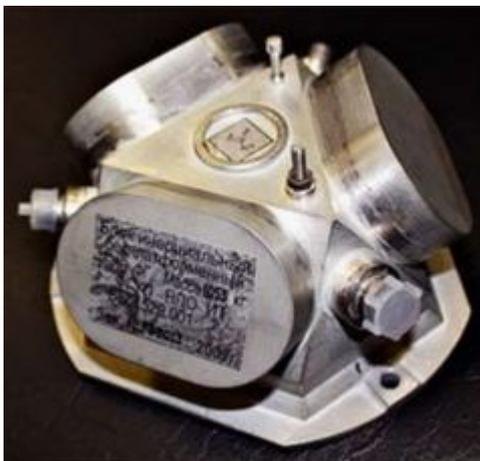
Бесплатформенный инерциальный блок на базе ВОГ (БИБ)
