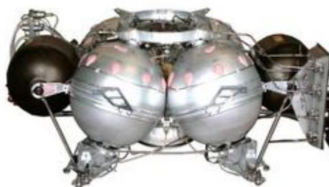
Двигательная установка возвращаемого аппарата (ДУ ВА)
