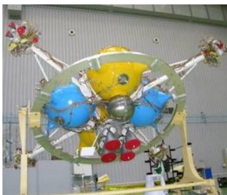
Многофункциональная двигательная установка перелетного модуля (МДУ ПМ)
