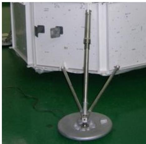
Испытания посадочного устройства
